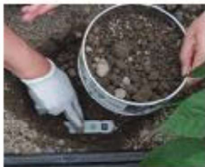
④センサを固定したまま、 その上に土をふるいます。
